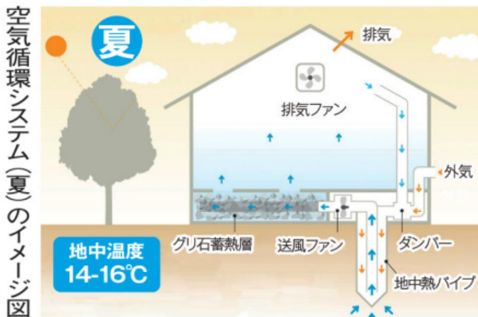
水戸市大塚町の新築・リフォームの設計施工会社「常陽ダイケンホーム」は、地中熱を利用した空気循環システム「GEO(ジオ)パワーシステム」を取り入れた家づくりを提案している。同システムは、山口県の会社「ジオパワーシステム」が開発したもので、年間を通して安定した温度を保っているという地中5㍍地点にパイプを埋設し、そのパイプを通った空気を室内に送ることで、夏は涼しく、冬は暖かい状態を実現できる。できる限り冷暖房機器に頼らない、省エネの暮らししが実現できるという。グッドデザイン賞など各賞を受賞。同社 ☎ 029・253・3326、☎ 090・2644・5547。
